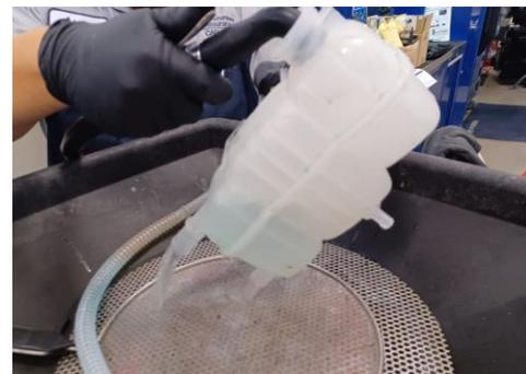
**SUBJECT:** COOLING SYSTEM CIRCUIT DEBRIS DISCHARGE AND COOLANT CHANGE
